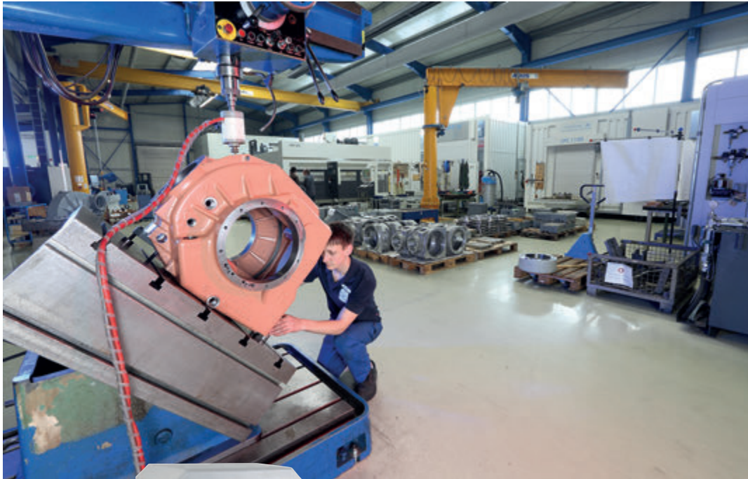
Raboma mit Schwenktisch Bearbeitungsmaße: 2.000 mm x 1.000 mm x 1.500 mm
