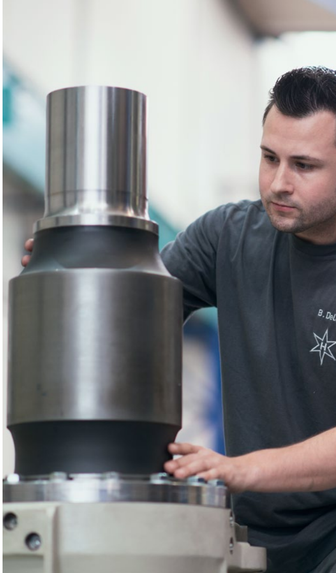
Przekładnia Top-Drive do napędu wiertła w wierceniu głębinowym
